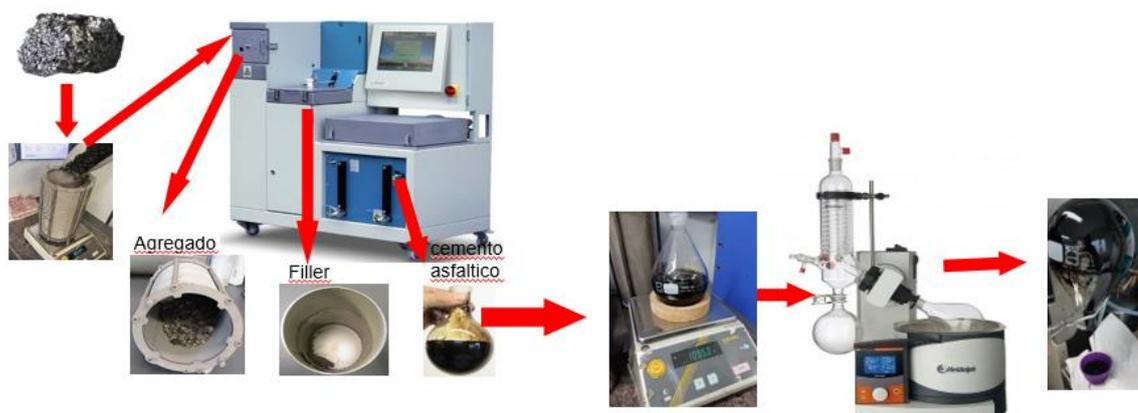
Figura 4. Asphalt analyser (infraTest) para extraer y recuperar el aglutinante asfáltico
