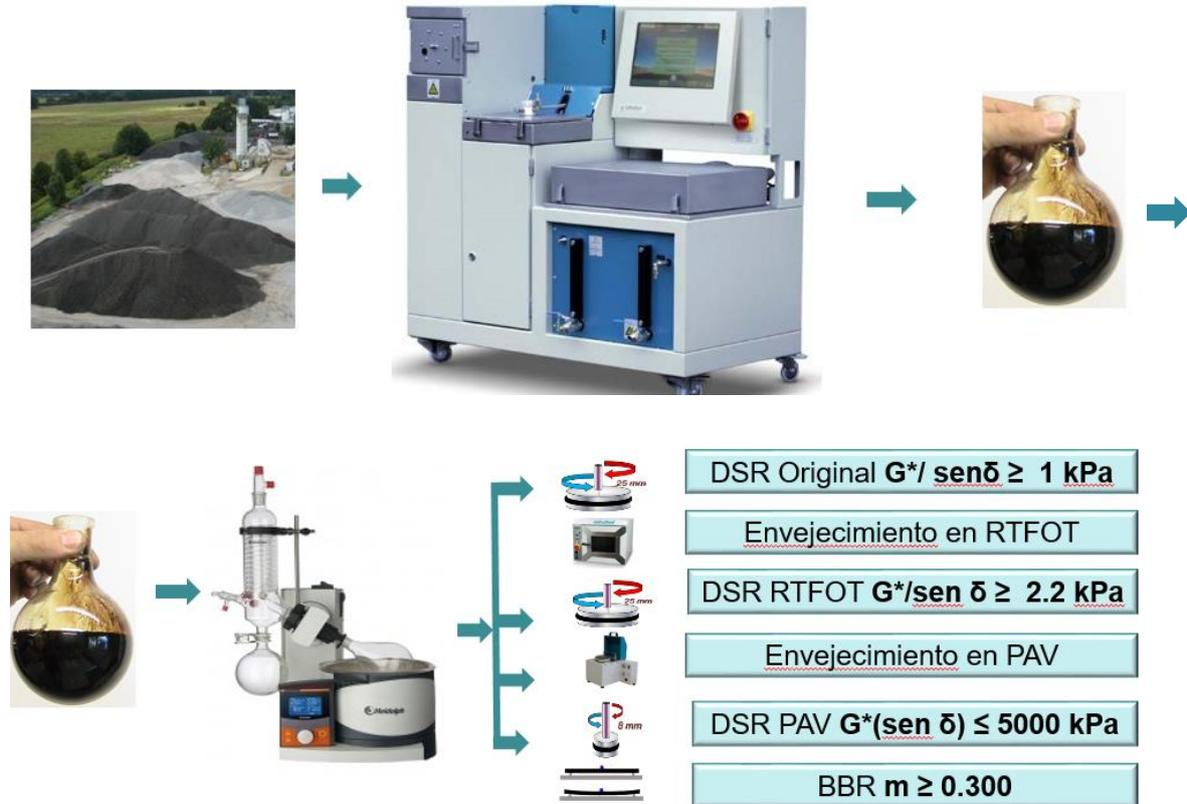
Figura 6. Pruebas de las características de los materiales en el método de la homogeneización
