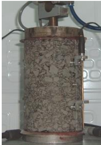
Figura 6. Probeta para ensayo de Compresión Uniaxial
