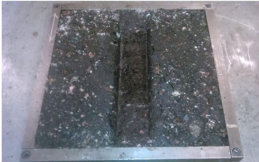
Figura 12. Probeta de WTT ensayada
