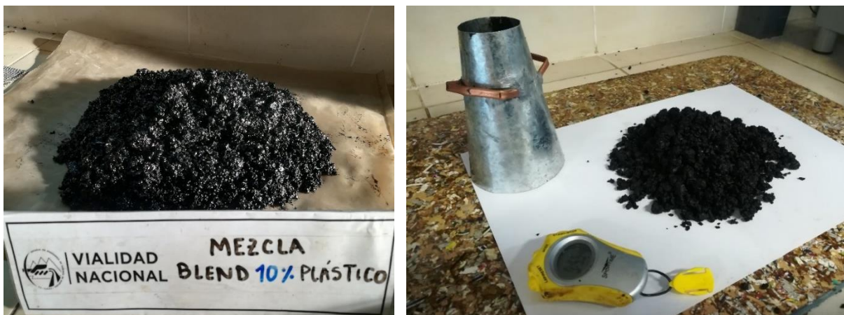
Figura 6. izquierda: mezcla evaluada, derecha: elementos del ensayo propuesto para la cuantificación de la trabajabilidad en mezclas almacenables
