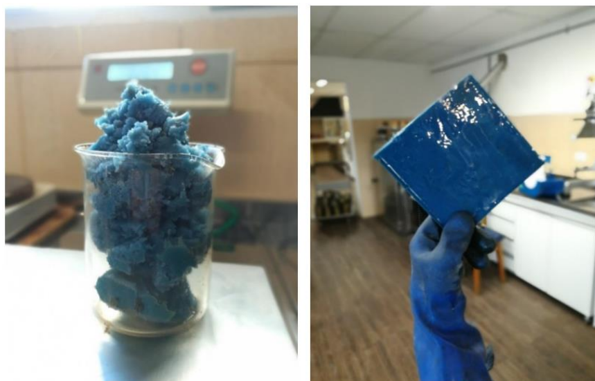
Figura 2. Consistencia del blend final, izquierda: blend elaborado con 10% plástico, derecha: blend elaborado con 50% plástico
