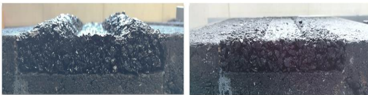
Figura 9. Probetas ahuelladas luego del ensayo de Wheel Tracking a 5000 ciclos, izquierda: mezcla QB00, derecha: mezcla QB50
